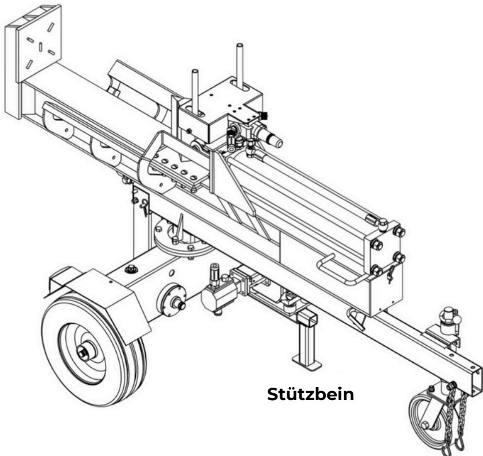
**Die Kupplung und die Holzablage an der Deichsel befestigen und mit Sechskantschrauben und Stoppmuttern sichern.**
