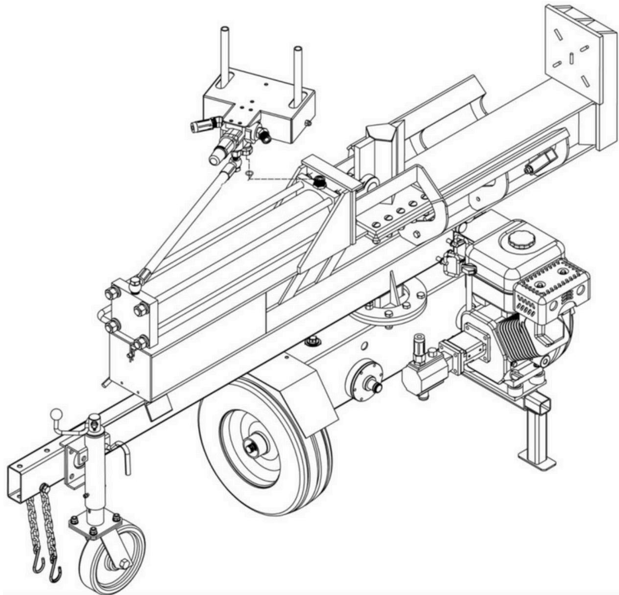
**Die Drehteller-Schrauben lösen und den Maschinenbalken um 90 Grad drehen, wie in der Abbildung gezeigt.**
