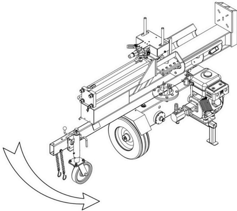
**Nach dem Drehen des Maschinenbalkens das Motorstützbein herausklappen und die Drehteller-Schrauben festziehen.**
